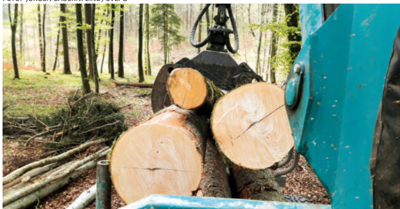
Auf gut geklemmte Stämme achten: Sonst besteht Durchrutschgefahr.
